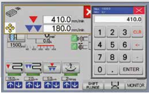
Setup-Screen für die kontinuierliche Scheibenquerverstellung ■ Kontinuierlicher Vorschub für Schruppen und Schlichten separat einstellen
